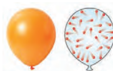
شکل ۲-۶ حرکت نامنظم ذرات گاز درون یک بادکنک
