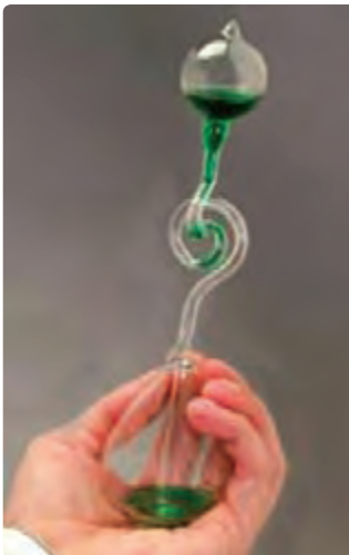
شکل ۴-۳۸ با در دست گرفتن حباب شیشه‌ای و گرم کردن آن، مایع رنگی در لوله مارییج بالا می‌رود.
