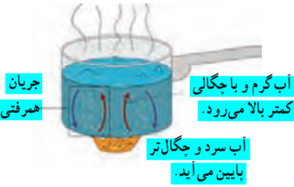
شکل ۴-۲۹ گرم شدن آب درون قابلمه به روش همرفت
