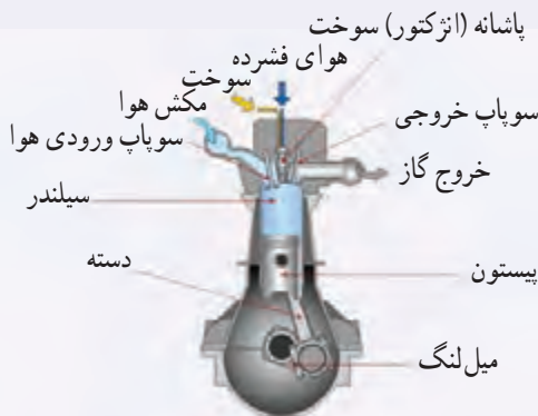
شکل ۵-۲۰ طرحی از اجزای یک ماشین دیزل
