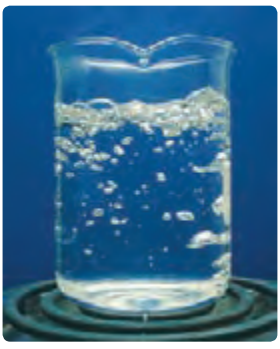
شکل ۴-۲۴ در هنگام جوشیدن، حباب‌ها از محل تشکیل خود به سمت سطح آزاد مایع بالا می‌روند.
