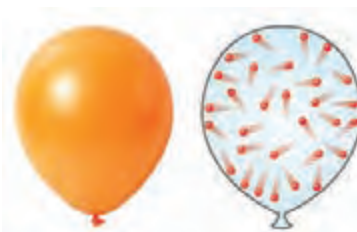
شکل ۲-۶ حرکت نامنظم ذرات گاز درون یک بادکنک
