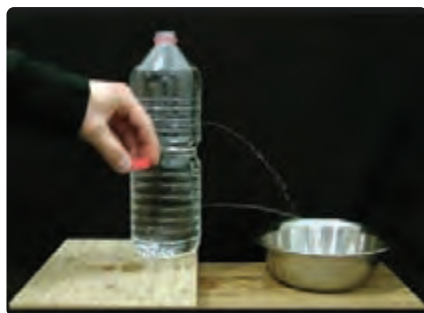
شکل ۲-۱۳ با باز کردن در بطری، آب از سوراخ‌های ایجاد شده در بطری، با فشار متفاوت خارج می‌شود. سرعت خروج آب از کدام سوراخ بیشتر است؟
